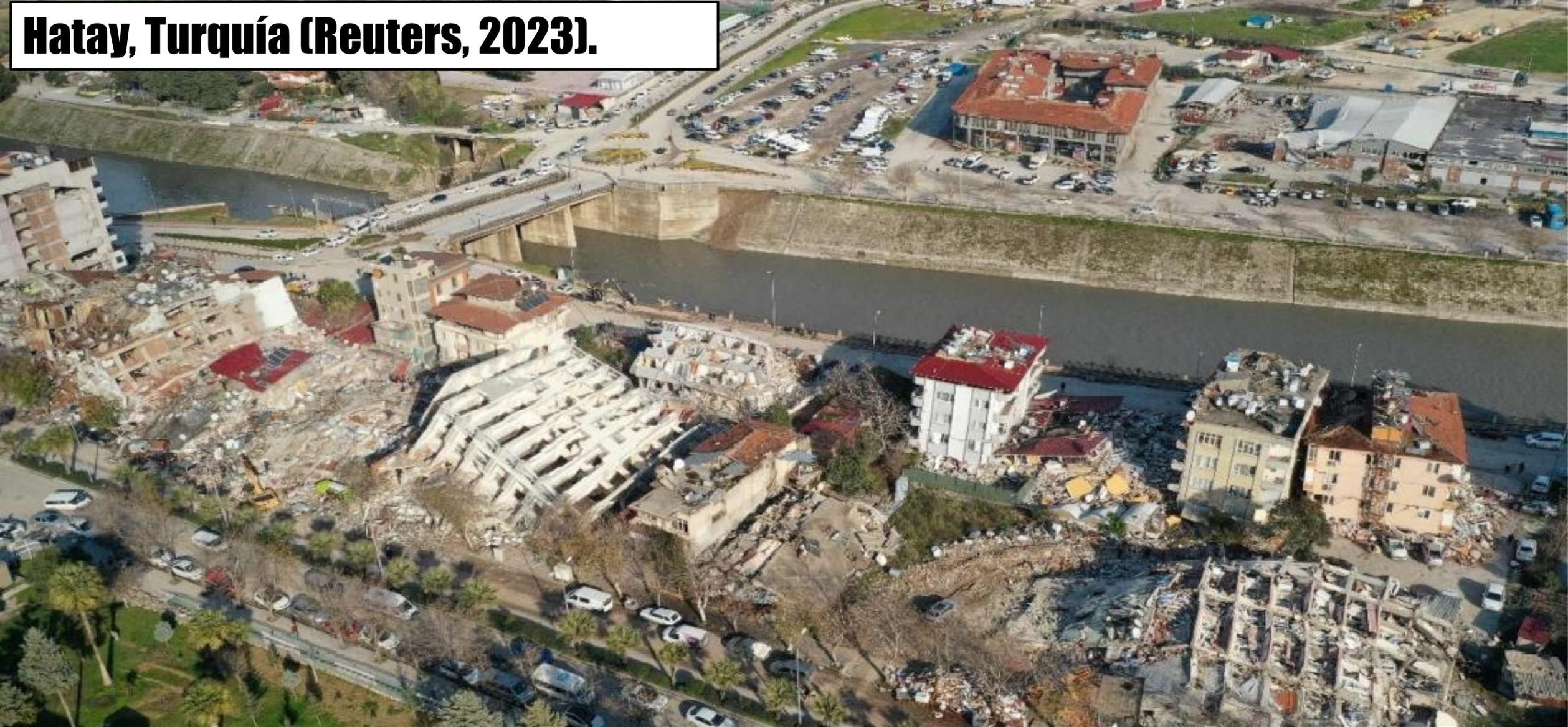
**EN LA FIGURA SE PUEDE APRECIAR QUE LA MAYORÍA DE LAS CONSTRUCCIONES UBICADAS ENTRE EL CANAL DE AGUA Y LA AVENIDA TUVIERON COLAPSO O DAÑO SEVERO. SE OBSERVA QUE LAS CONSTRUCCIONES TIENEN ENTRE 3 Y 9 NIVELES.**
