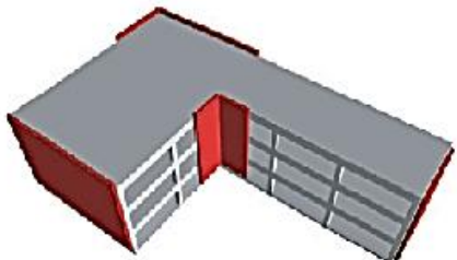
Restringir el movimiento de las Alas y rigidizar las zonas con mayor concentración de esfuerzos
