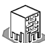
Interrupción de elementos verticales resistentes
